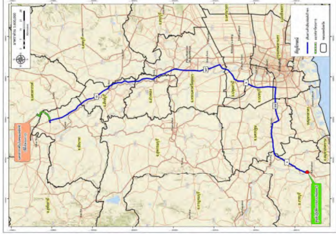
รูปที่ 2 เส้นทางขนส่งท่อก๊าซฯ มายังพื้นที่เก็บกองท่อและวัสดุก่อสร้างของโครงการ
